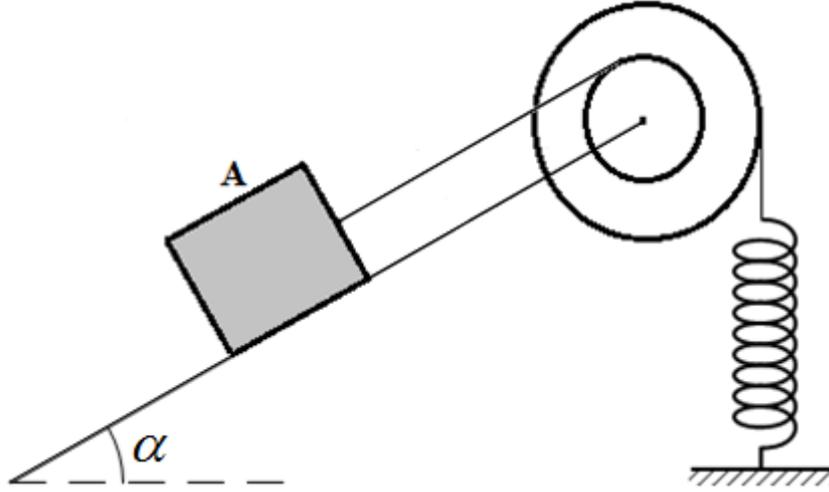
1. Déterminer l'expression de l'allongement  $\Delta l_0$  du ressort à l'équilibre en fonction de  $m_A$ ,  $R$ ,  $r$ ,  $\alpha$ ,  $K$ , et  $g$ . Calculer  $\Delta l_0$
