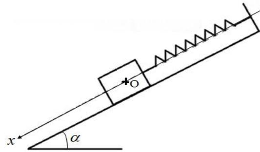
1.  $O$  est la position de  $G$  lorsque le solide (S) est en équilibre. Déterminer en fonction de  $K$ ,  $m$ ,  $g$  et  $\alpha$  l'allongement  $\Delta\ell_0$  du ressort lorsque (S) est au repos.
