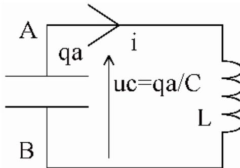
La tension  $u_c$  aux bornes du condensateur dans le circuit LC série est solution de l'équation différentielle du second ordre :
