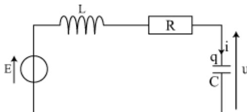
Le condensateur est initialement déchargé et l'interrupteur ouvert ( $u_C = 0$  et  $i = 0$ ).
