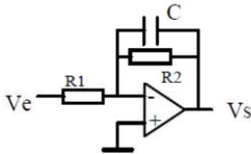
Pour déterminer la fonction de transfert, notons  $Z = C//R_2$ .
