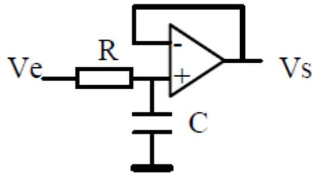
Ce filtre à exactement les mêmes caractéristiques que le filtre passif du premier ordre. Elle a seulement l'avantage d'être suivi par un amplificateur suiveur à très haute impédance d'entrée et très faible impédance de sortie. De cette façon, ses caractéristiques ne sont pas altérées par les composants qui seront reliés à sa sortie.
