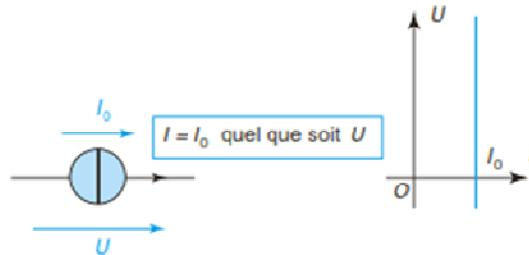
Le courant de sortie  $I$  est indépendant de la tension entre les bornes du générateur. Cela suppose une résistance interne infinie. Elle ne peut jamais être mise à vide, sous peine de voir la tension à ses bornes infinie.
