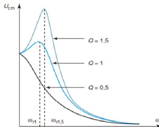
On constate bien sûr sur ce graphe qu'il n'y a pas de résonance si  $Q = 0,5$  ( $Q < \frac{1}{\sqrt{2}} = 0,71$ ) et que la pulsation de résonance est d'autant plus grande que  $Q$  est grand ( $\omega_{r1} < \omega_{r1,5}$ ).
