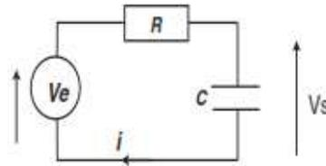
► En BF :  $\omega(x) \rightarrow 0 \Rightarrow \frac{1}{jC\omega} \rightarrow \infty$  (le condensateur se comporte comme un interrupteur ouvert) ,donc le courant est nul et par conséquent  $v_s(t) = v_e(t)$
