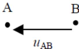
Elle est souvent confondue avec la différence de potentiel électrique entre deux points d'un circuit électrique, car les deux notions coïncident en régime stationnaire et sont approximativement équivalentes dans de nombreuses applications pratiques en régime variable.
