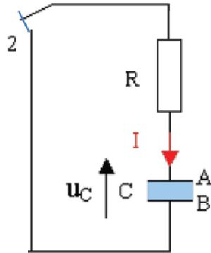
À  $t = 0$ , on ouvre l'interrupteur (l'interrupteur passe en position 2), le condensateur se décharge dans la résistance :
