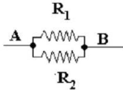
On doit avoir  $i = i_1 + i_2$  et  $R_1 i_1 = R_2 i_2$
