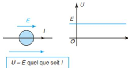
La tension aux bornes de la source de tension idéale est égale à la force électromotrice  $E$  du générateur. Elle est indépendante du courant qu'elle délivre. Cela suppose que sa résistance interne est nulle. Elle ne peut jamais être mise en court circuit, sous peine de devoir débiter un courant infini, tout en ayant une tension constante à ses bornes.
