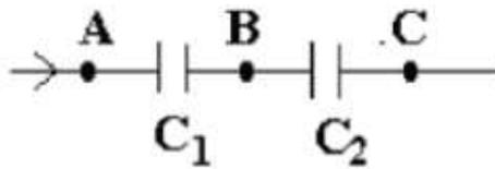
Pour le condensateur  $C_1$ ,  $u_1 = u_A - u_B = \frac{q}{C_1}$
