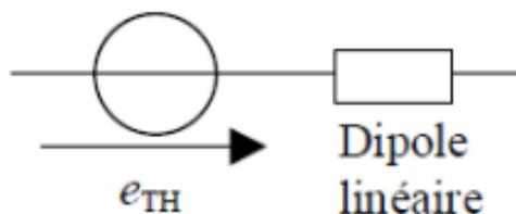
En continu la source de tension est une source de tension continue et le dipôle linéaire une résistance.
