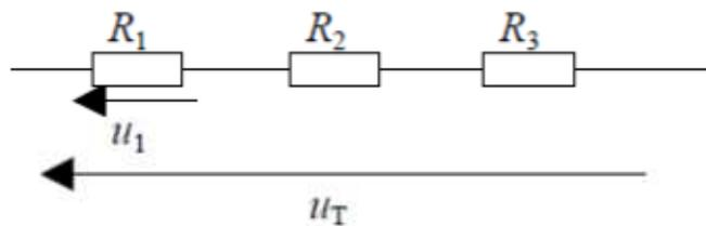
Lorsque plusieurs résistances sont en série, la tension aux bornes de l'une d'entre elle peut être déterminée par la relation :
