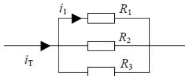
Lorsque plusieurs résistances sont en parallèle, le courant qui traverse l'une d'entre elle peut être calculé par la relation :
