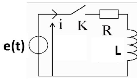
Il s'agit d'un circuit comportant en série: une bobine d'inductance  $L$ , un conducteur ohmique de résistance  $R$ , un interrupteur. Ce circuit est soumis à un échelon de tension.
