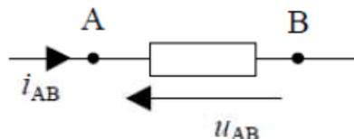
Le courant et la tension sont fléchés en sens inverse. Cela permet d'obtenir deux grandeurs positives pour des dipôles s'opposant à la circulation du courant.
