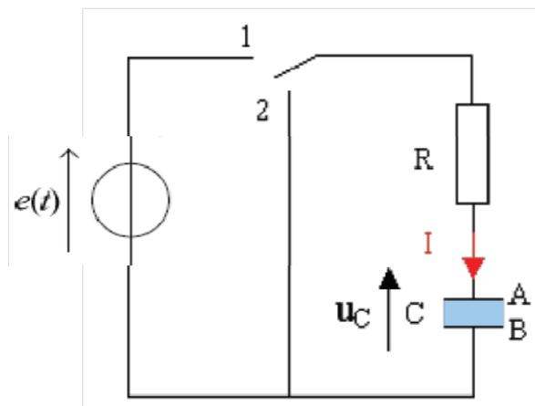
Le circuit comporte un condensateur en série avec une résistance, une source de tension et un interrupteur. Le sens positif choisi est les sens de circulation du courant. Il est indiqué par la flèche rouge.
