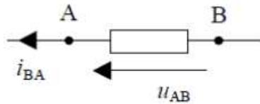
Le courant et la tension sont fléchés dans le même sens. Cela permet d'obtenir deux grandeurs positives pour des dipôles favorisant la circulation du courant.
