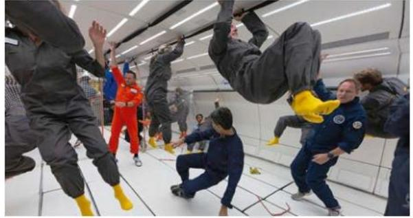
Le CNES réalise depuis 1998 des expériences scientifiques et technologiques en situation à bord de l'Airbus A300-Zéro G. L'avion effectue une série de 30 paraboles pendant lesquelles on accède à des conditions semblables à l'absence de pesanteur (appelée maintenant impesanteur plutôt qu'apesanteur) ressentie dans l'espace.
