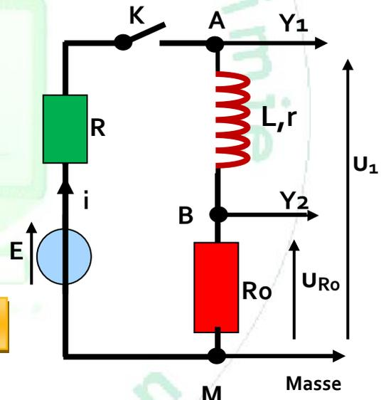
On ferme l'interrupteur à un instant choisi comme origine des dates (**t=0**). Les courbes (**C1**) et (**C2**) de la **figure -4-** (**page-5/5**) représentent les tensions visualisés sure les voie **Y1** et **Y2** de l'oscilloscope bicourbe
