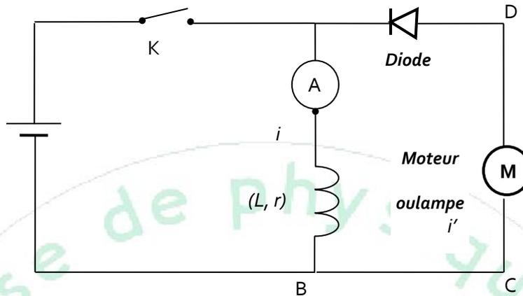
On ferme l'interrupteur K. L'ampèremètre détecte un courant *i* non nul. Le moteur ne tourne pas (la lampe ne s'allume pas) car la diode est bloquée.
