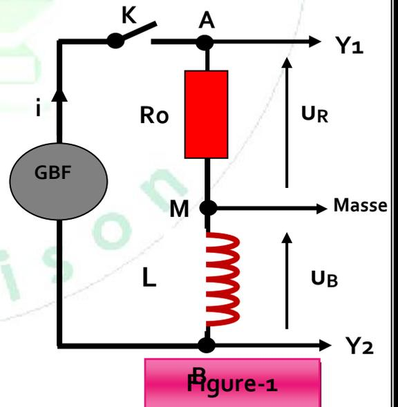
On ferme l'interrupteur **K** et à l'aide de l'oscilloscope, on visualise simultanément la tension  $u_R(t) = u_{AM}(t)$  aux bornes de résistor **R** sur la voie **Y<sub>1</sub>** et la tension  $u_B(t) = u_{BM}(t)$  aux bornes de la bobine sur la voie **Y<sub>2</sub>**.
