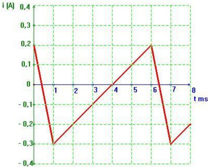
L'intensité du courant traversant une bobine idéale d'inductance  $L = 10 \text{ mH}$  a l'allure représentée ci-contre. La bobine est étudiée en convention récepteur.
