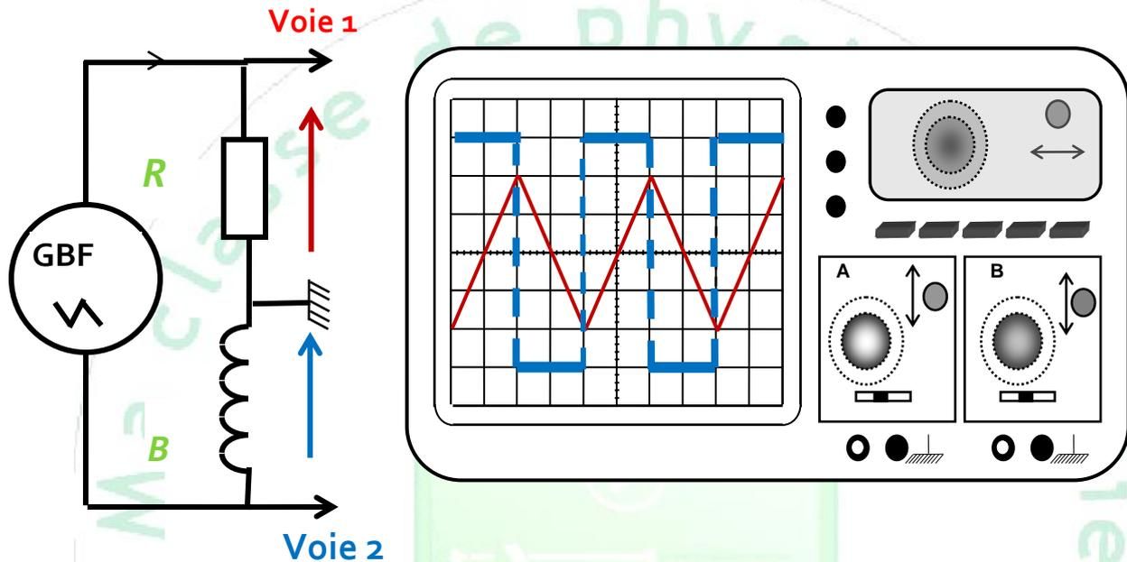
On visualise simultanément la tension  $u_R$  aux bornes du résistor sur la voie Y1 et la tension  $u_B$  aux bornes de la bobine ( $B$ ) sur la voie Y2 de l'oscilloscope
