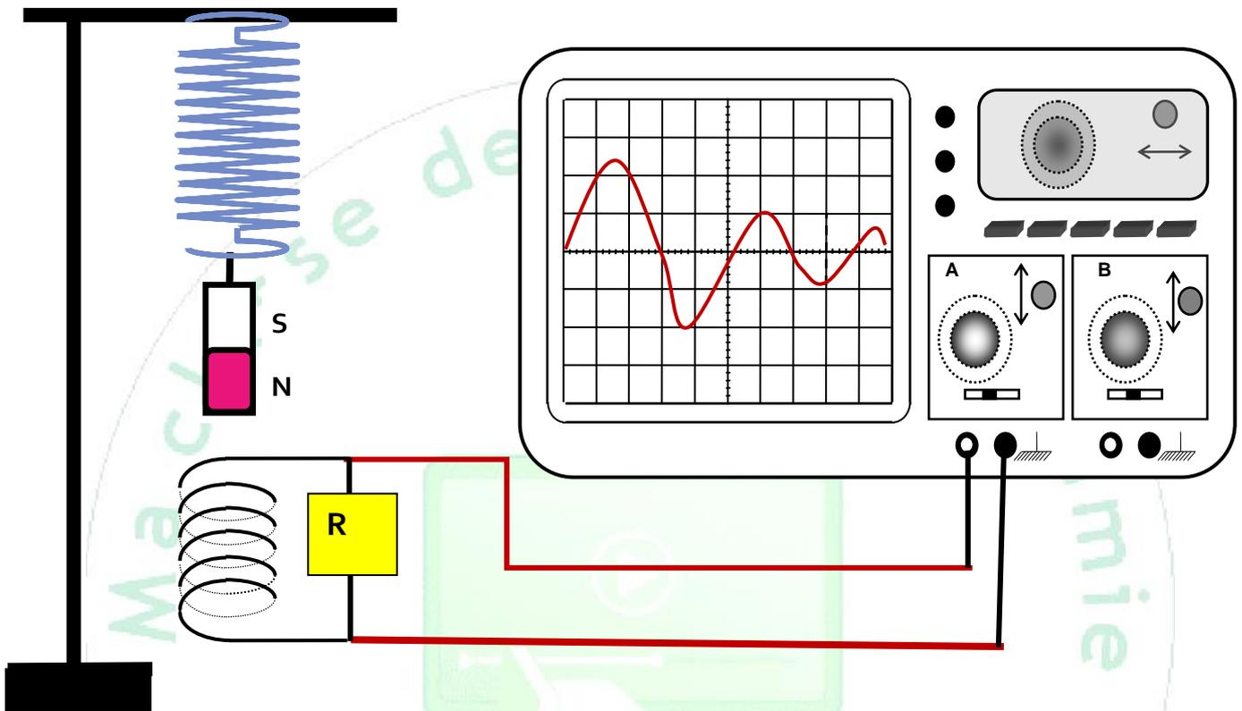
On comprime le ressort puis on le lâche, l'aimant se met en mouvement, On observe l'oscillogramme ci-dessus
