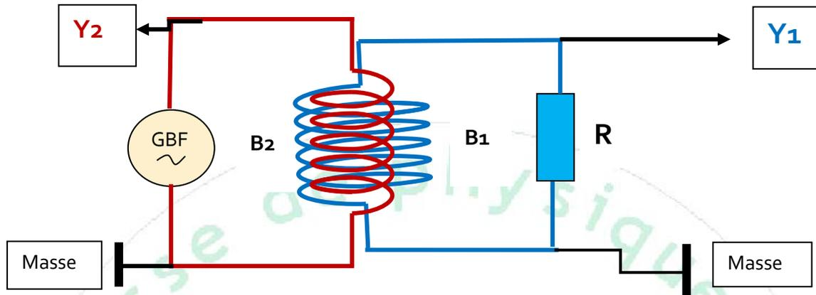
En appliquant, aux bornes du solénoïde (B2) une tension sinusoïdale, on observe aux bornes de la bobine (B1) une tension de forme semblable
