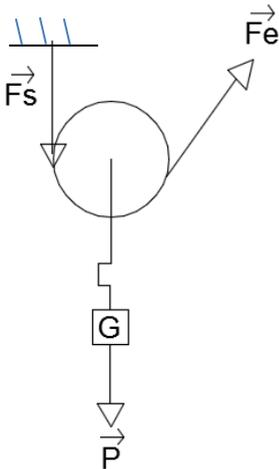
Avec une poulie mobile l'intensité de la force entrée  $\|\vec{F}_e\|$  est égale à la moitié de l'intensité de la force sortie  $\|\vec{F}_s\|$
