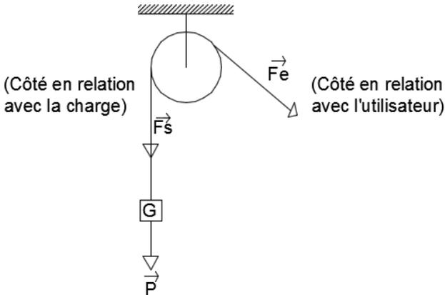
Nous constatons quelque fois l'inclinaison du fil : la norme de  $\|\vec{F}_e\|$  est égale à la norme de  $\|\vec{F}_s\|$ .
