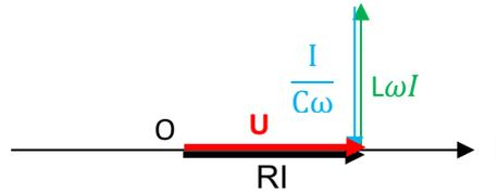
Si  $\varphi < 0$  c'est-à-dire  $L\omega < \frac{1}{C\omega}$  ; u est en retard sur i ; le circuit est dit capacitif est le diagramme de Fresnel est :
