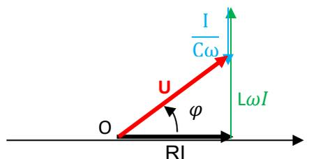
Si  $\varphi = 0$  c'est-à-dire  $L\omega_0 = \frac{1}{C\omega_0}$  ; u et i sont en phase ; on dit qu'on est à la résonance
