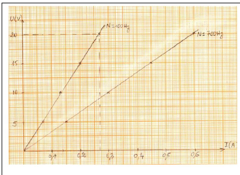
Pour chaque fréquence on obtient une droite qui passe par l'origine des axes. La tension efficace est donc proportionnelle à l'intensité efficace  $I$ . Le coefficient de proportionnalité noté  $Z$  est appelé l'impédance du circuit RLC.
