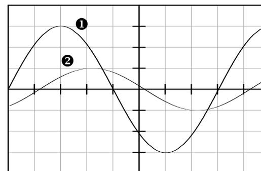
**9** Une portion de circuit BM comportant une bobine de résistance  $R = 14,8 \Omega$  et d'inductance  $L = 0,10H$ , un condensateur de capacité  $C$  et un conducteur ohmique de résistance  $R_1 = 10 \Omega$  est alimentée par un générateur produisant une tension alternative sinusoïdale de fréquence réglable et de valeur efficace constante.
