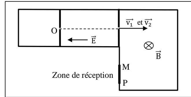
9 Dans un canon à électrons, les électrons émis dans le vide par la cathode C avec une vitesse pratiquement nulle sont accélérés par l'anode A ; la différence de potentiel entre l'anode et la cathode est  $U = V_A - V_C = 140$  V.
