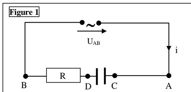
On utilise un oscillographe (voies I et II) pour visualiser la tension  $u_{DB}$  aux bornes du conducteur ohmique et la tension  $u_{AB}$  aux bornes du dipôle RC.
