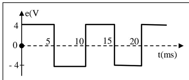
**3** Dans un montage intégrateur,  $C = 0,1 \mu\text{F}$  et  $R = 10 \text{ k}\Omega$ . La tension appliquée à l'entrée,  $u_e$ , est une tension en créneaux de fréquence  $N = 200 \text{ Hz}$  et d'amplitude  $U = 2 \text{ V}$ .
