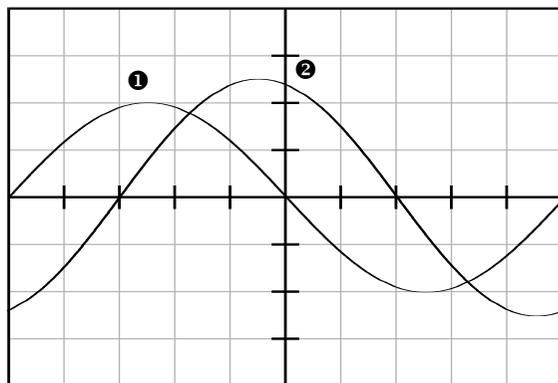
Les réglages de l'oscilloscope sont les suivants : voie 1 : sensibilité  $0,2 \text{ V.cm}^{-1}$  ; voie 2 : sensibilité  $2 \text{ V.cm}^{-1}$  ; balayage :  $0,1 \text{ ms.cm}^{-1}$ .
