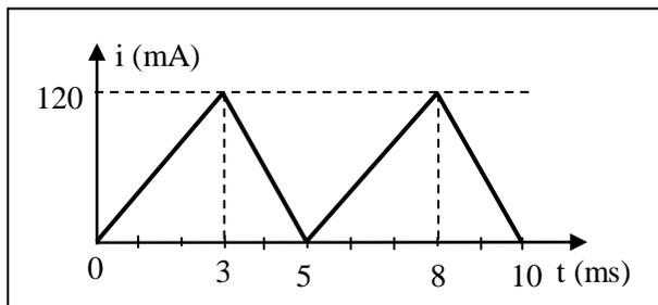
**2** Soit un solénoïde (A, C) de résistance négligeable, de longueur  $\ell = 1 \text{ m}$ . Il comporte  $N = 1000$  spires circulaires de rayon  $r = 5 \text{ cm}$ . Le sens de l'orientation pour l'intensité  $i$  est choisi de A vers C dans le solénoïde.
