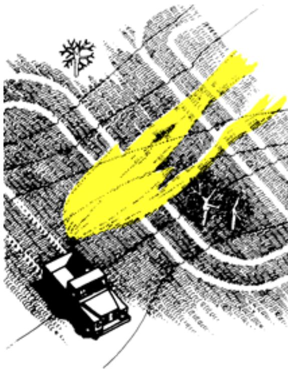
**Figure 10.** – Pulvérisateur monté sur pot d'échappement d'un véhicule tout terrain ENS ou "Exhaust nozzle sprayer" pour traiter en dérive contrôlée.
