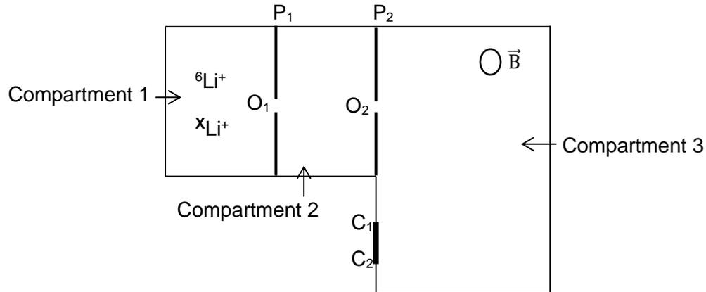
Les ions  ${}^6\text{Li}^+$  et  ${}^X\text{Li}^+$ , de même charge  $q$  et de masses respectives  $m_1$  et  $m_2$ , sont produits dans le compartiment 1 et sortent en  $O_1$  avec une vitesse nulle. Sous une tension accélératrice  $U$ , les ions sortent du compartiment 2 et pénètrent dans le compartiment 3, où règne un champ magnétique uniforme  $\vec{B}$  perpendiculaire au plan de la figure. Les ions sont collectés en  $C_1$  et  $C_2$ .
