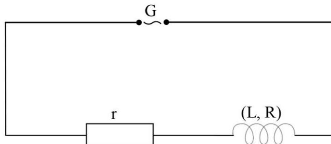
On désire étudier à l'oscilloscope bicourbe ce circuit en visualisant la tension  $u(t)$  fournie par  $G$  sur la voie  $Y_A$  et l'intensité  $i(t)$  du courant dans le circuit sur la voie  $Y_B$ .
