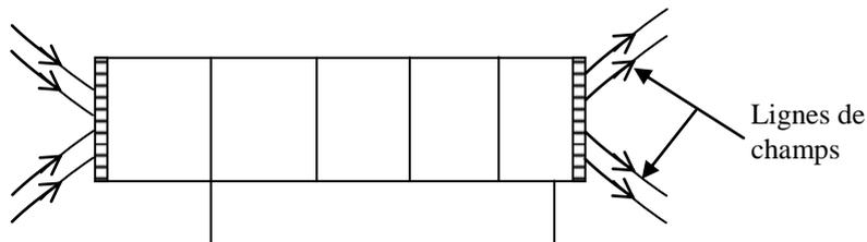
B) Pour utiliser ce solénoïde, on se propose de déterminer son nombre de spires. Pour ce faire, on mesure la valeur du champ magnétique  $\vec{B}$  au centre du solénoïde en faisant varier l'intensité du courant  $I$  qui le traverse.
