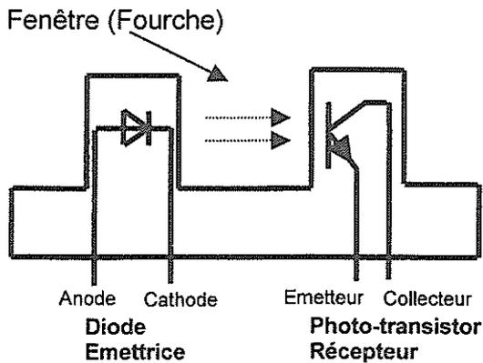
Application : détection du passage d'un obstacle à l'intérieur de la fourche.
