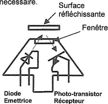
Application : détection de la présence d'un objet réfléchissant (blanc) en face de la fenêtre.
