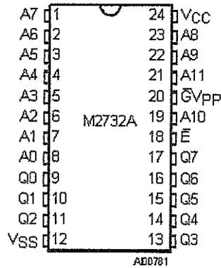
**Description :** La M2732A est une mémoire EPROM électriquement programmable et effaçable par UV d'une capacité de 32768 bits. Elle est organisée sous la forme de 4096 mots de 8 bits. La M2732A possède une alimentation unique de 5V et un temps d'accès de 200 ns, elle est idéale pour les applications où la rapidité est importante.
