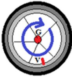
Figure 4.9 : Mvt de la valve d'une roue
