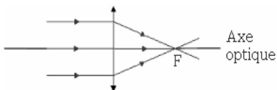
L'action d'une lentille convergente sur des rayons parallèles
