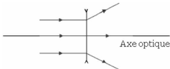
Action d'une lentille divergente sur des rayons parallèles
