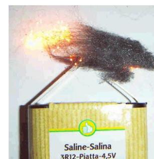
Lorsqu'on court-circuite la pile électrique :
