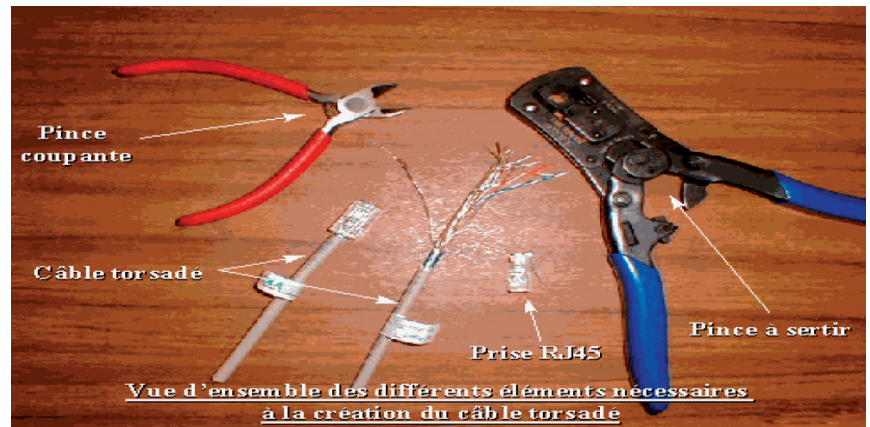
Figure 5.1 : Matériel nécessaire au sertissage des câbles à paires torsadées
