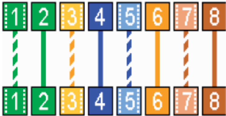
Figure 5.4 : Agencement de fils pour câble droit
