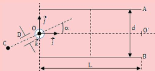
Un faisceau homocinétique de protons, émis en C à vitesse négligeable, est accéléré entre les points C et D, situés dans le plan  $(O ; \vec{i} ; \vec{j})$ . Il pénètre en O, dans le champ électrique du condensateur supposé uniforme, incliné par rapport à  $\vec{i}$  d'un angle  $\alpha$ .
