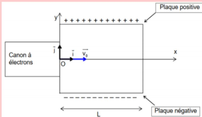
**Données de l'expérience :** Les électrons sortent du canon à électrons avec une vitesse  $v_0 = 2,27 \cdot 10^7$  m/s. Le faisceau d'électrons passe entre les deux plaques chargées et est dévié d'une hauteur  $h$  quand il sort des plaques. L'intensité du champ électrostatique entre les deux plaques est :  $E = 15,0$  kV/m. La longueur des plaques est :  $L = 8,50$  cm. On fait l'hypothèse que le poids des électrons est négligeable par rapport à la force électrostatique  $\vec{F}$ .
