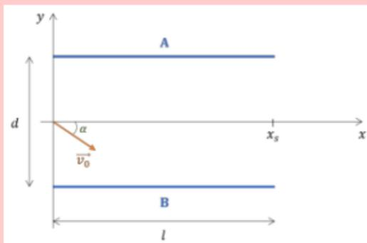
Un électron entre avec une vitesse initiale  $\vec{v}_0$  de norme  $2,5 \cdot 10^6$  m/s entre les plaques chargées d'un condensateur plan. Le vecteur vitesse fait un angle de  $30^\circ$  avec l'axe  $x$  comme indiqué sur la figure et l'expérience se fait dans le vide. Les plaques A et B ont une longueur de  $\ell = 6$  cm et sont distantes de  $d = 4$  cm. Le réglage de la tension  $U_{AB}$  permet de faire varier l'ordonnée du point S où les électrons sortent du champ électrique.
