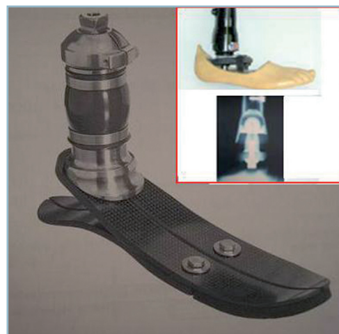
11.86 Appareillage moderne-Cheville prothétique avec pièce intermédiaire dynamique (effet de pompe active avec dépression contrôlée améliorant la coaptation manchon/moignon et système d'amortissement et de torsion intégré).
