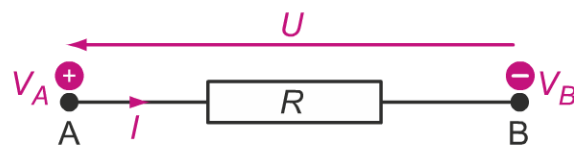
Figure 1.6 – Loi d'Ohm aux bornes d'une résistance.
