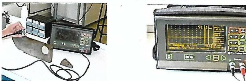
Figure 19 : Mesure d'une fissure interne par ultrasons
