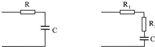
Figure 6.19 Principaux filtres élémentaires d'une PLL.
