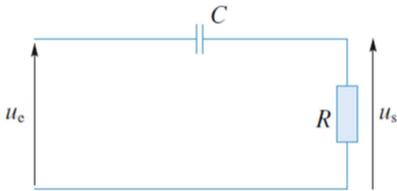
1. Déterminer la fonction de transfert  $H(j\omega)$  de ce filtre. Tracer le diagramme de Bode.
