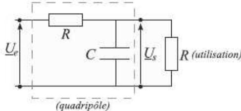
Vu du générateur, le circuit est formé d'une résistance  $R$  en série avec l'association parallèle (condensateur, résistance) soit  $\underline{Z}_e = R + \frac{1}{\underline{Y}_C + \underline{Y}_R}$  donc
