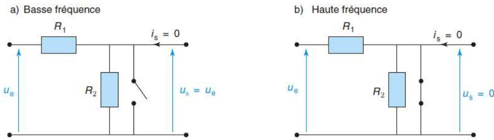
➤ **2** Soit  $\underline{Z}$  l'impédance de l'association du condensateur et du résistor de résistance  $R_2$ , et  $\underline{Y}$  son admittance.
