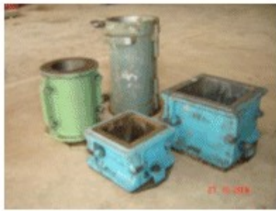
La dimension de l'éprouvette pour mesurer la résistance en compression
