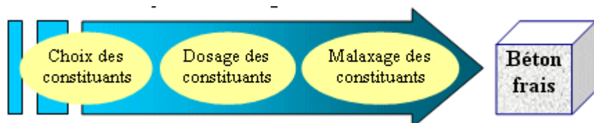
fig. 7.3: Schéma de la fabrication du béton frais
