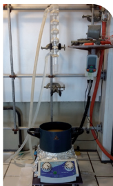
Bain d'huile thermostaté. La température est régulée par la température d'ébullition du solvant utilisé (35 à 300 °C environ).
