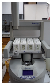
Appareil de synthèse sous micro-onde muni d'un passeur d'échantillons. La puissance programmable permet de fixer la température et la pression. Nécessite l'emploi d'un solvant polaire (alcool, eau, DMF...).
