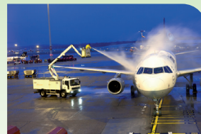
L'éthylèneglycol est utilisé comme antigel ou dégivrant (ici pour un avion)
