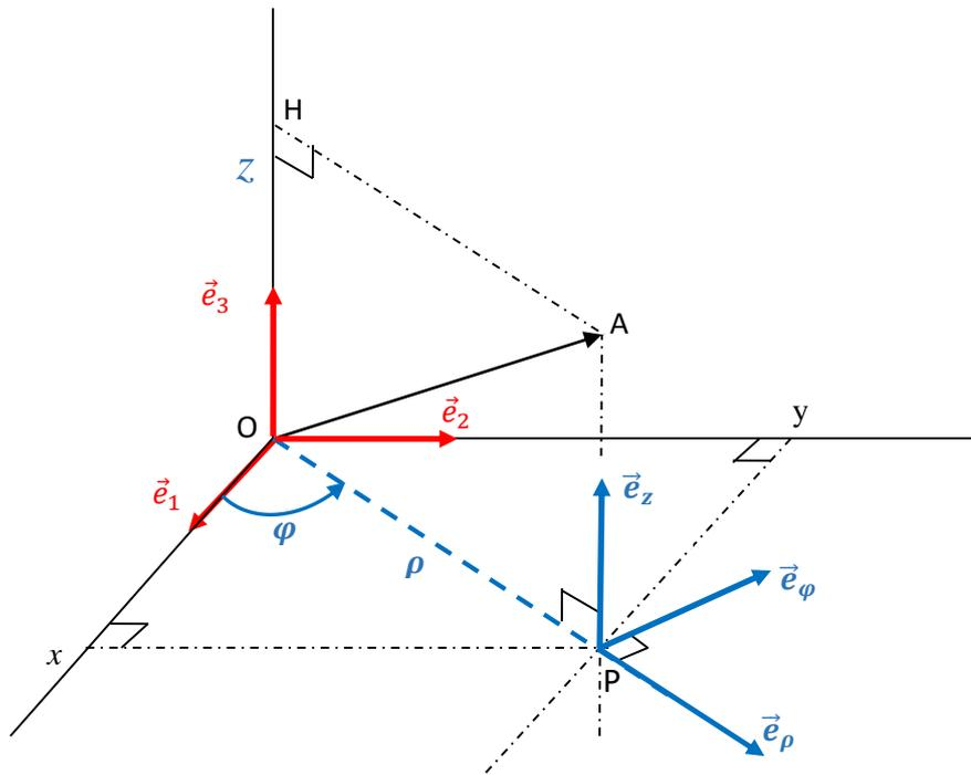
Figure 5 : repère cylindrique  $R_2(O; \vec{e}_\rho, \vec{e}_\varphi, \vec{e}_z)$
