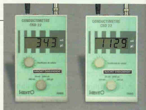
Doc. 12 Résultats des mesures à 25 °C : \sigma_1 = 343 \mu\text{S} \cdot \text{cm}^{-1} ; \sigma_2 = 1129 \mu\text{S} \cdot \text{cm}^{-1} .
