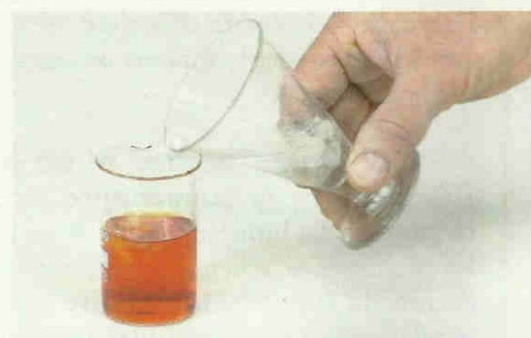
Doc. 13 Pour arrêter une réaction, on peut également diluer le milieu réactionnel avec un mélange d'eau et de glace pilée. On utilise ainsi simultanément les facteurs cinétiques température et concentration.
