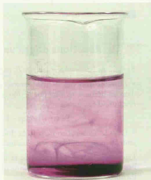
Doc. 11 La coloration due aux ions \text{MnO}_4^- se répand peu à peu dans tout le mélange : ce phénomène, appelé diffusion, est une manifestation de l'agitation thermique dans les liquides.
