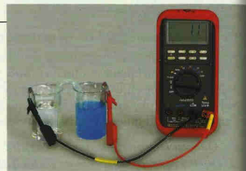
Doc. 9 Mesure de la force électromotrice ou f.é.m. de la pile.
