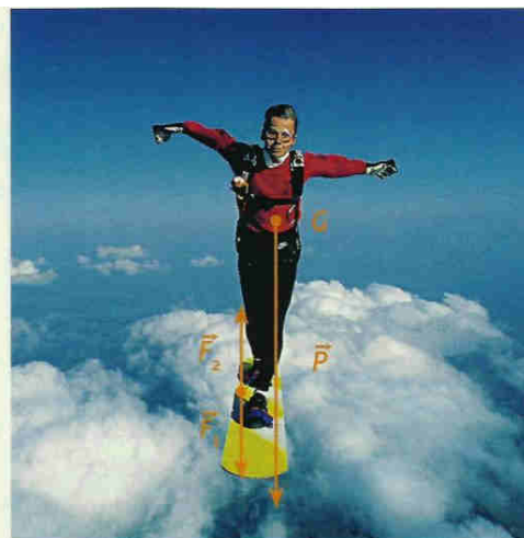
Doc. 4 \vec{F}_1 et \vec{F}_2 sont des forces intérieures. \vec{P} est une force extérieure appliquée au skysurfeur.
