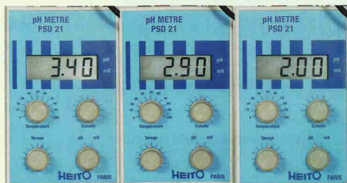
Doc. 2 Mesure du pH des solutions : \text{pH}_{S_1} = 3,40 ; \text{pH}_{S_2} = 2,90 ; \text{pH}_{S_3} = 2,00 .
