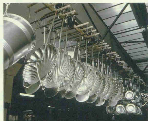
Doc. 11 L'argenture est réalisée par électrolyse.
