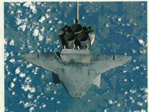
Doc. 16 La navette spatiale est munie d'un bouclier thermique qui la protège lors de son entrée dans l'atmosphère.
