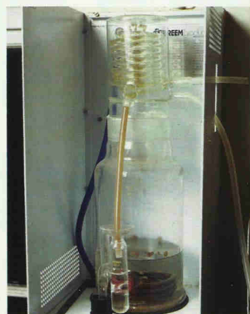
Doc. 2 Cet appareil permet d'obtenir de l'eau distillée. Pour obtenir de l'eau pure, il faut réaliser plusieurs distillations successives et utiliser une verrerie adaptée.
