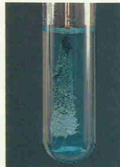
Doc. 3 Réaction entre le cuivre et les ions argent (I). Des aiguilles d'argent apparaissent alors que la solution bleuit progressivement.
