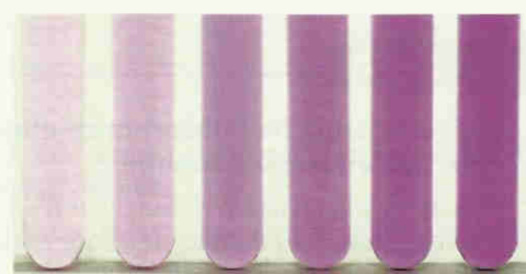
Doc. 12 Dans des récipients d'épaisseur identique, la coloration semble de plus en plus intense quand la concentration de la solution augmente.
