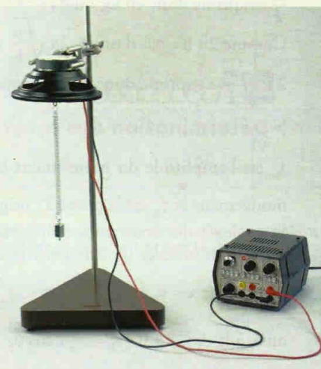
Doc. 10 Oscillations d'un dispositif solide-ressort fixé à la membrane d'un haut-parleur.
