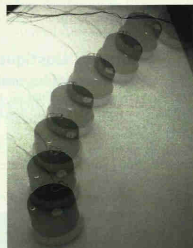
Doc. 17 Chronophotographie d'un mobile autoporteur sur une table horizontale, obtenue avec une caméra que l'on bouge.
