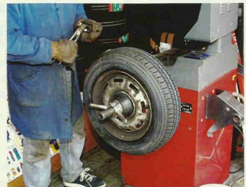
Doc. 12 Équilibrage d'une roue : des surcharges sont placées à la périphérie de la jante pour ramener le centre d'inertie de la roue sur l'axe de rotation.
