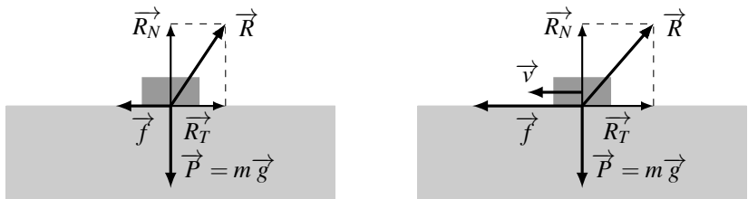
Figure 15.6 – À gauche, la force \vec{f} est insuffisante pour mettre le solide en mouvement sur son support horizontal. Elle est compensée par les frottements solides \vec{R}_N . À droite, la force de poussée \vec{f} est plus grande et on a dépassé le seuil d’adhérence. Le solide glisse sur son support.
