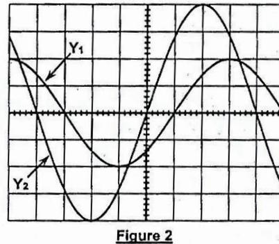
Sur les deux voies  $Y_1$  et  $Y_2$  de l'oscilloscope, le balayage horizontal a pour valeur  $S_h = 2,5 \text{ ms.div}^{-1}$  et la sensibilité verticale est  $S_v = 1 \text{ V.div}^{-1}$ .
