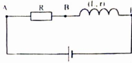
L'intensité du courant qui traverse le circuit est  $I_1 = 200 \text{ mA}$  et la résistance  $R$  a pour valeur  $30 \Omega$ .
