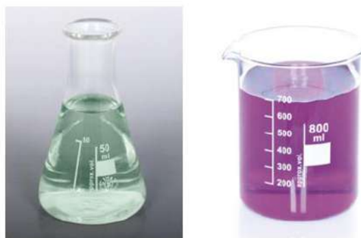
À l'équivalence, la couleur de la solution passe du vert \text{Fe}^{2+}(\text{aq}) au violet \text{MnO}_4^-(\text{aq}) .
