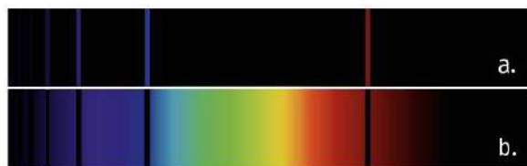
Spectres d'émission (a) et d'absorption (b) de l'atome d'hydrogène.
