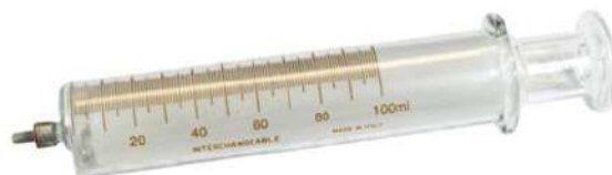
Seringue utilisée pour vérifier la loi de Mariotte.
