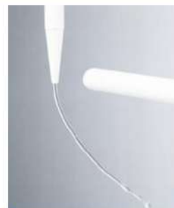
► La déviation d'un filet d'eau sous l'effet d'un bâton paille électrisé.
