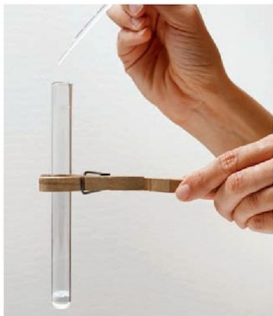
FIG. 1 Test au sulfate de cuivre anhydre
