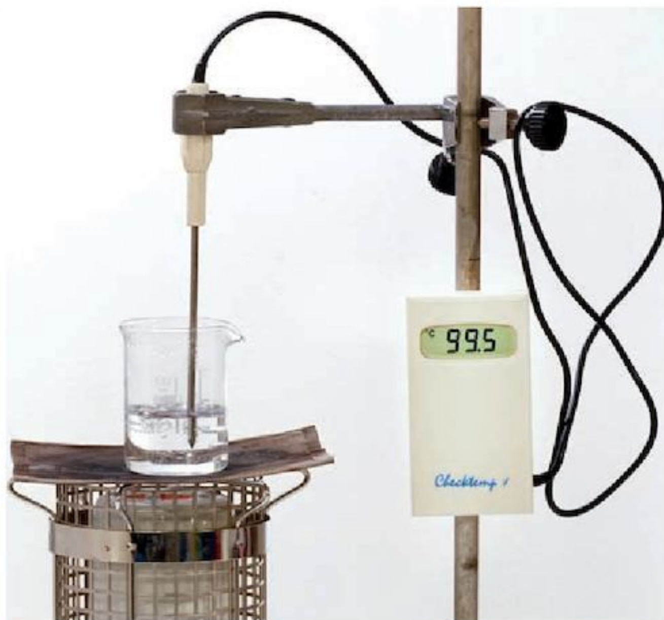
FIG. 1 Ébullition de l'eau à la pression environnante
