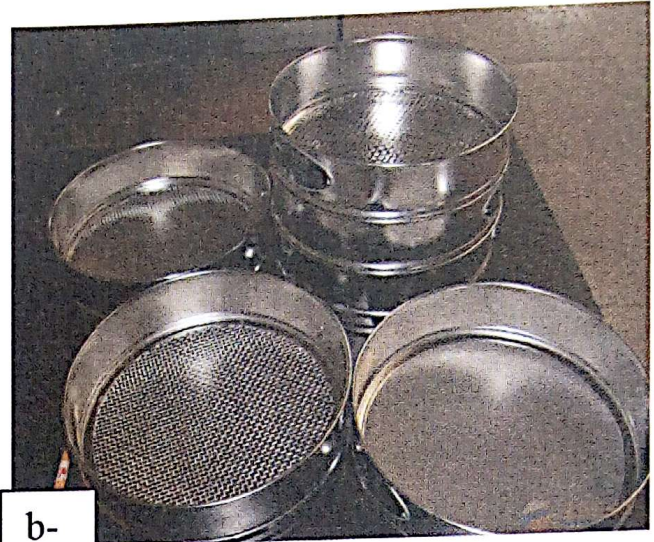
Fig 1 : Deux colonnes de tamis dissociés.
