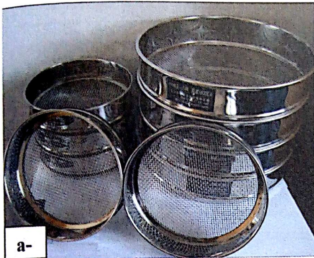
Fig 1 : Deux colonnes de tamis dissociés.
