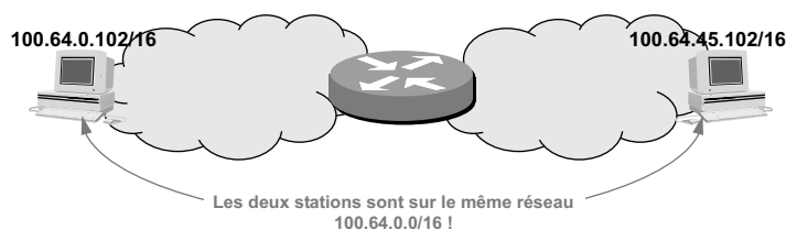
Figure 19.65 Le réseau défaillant.
