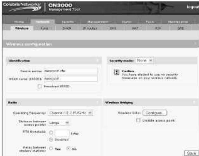
Figure 4.14 – Exemple d'interface web d'administration d'un point d'accès.
