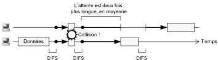
Figure 3.4 — La gestion des collisions avec le CSMA/CD.
