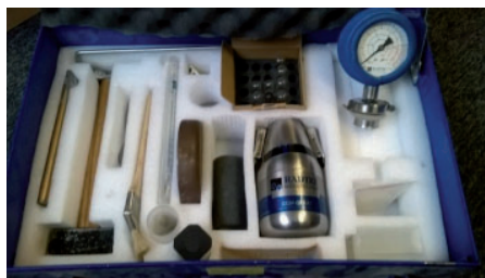
Figure 8.2 - Test à la bombe au carbure
