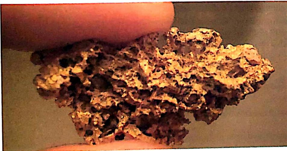
Document 4c : Or purifié par la méthode électrolyse chimique
