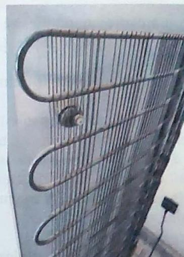
Serpentin d'un réfrigérateur (condenseur) où passe le gaz réfrigérant.
