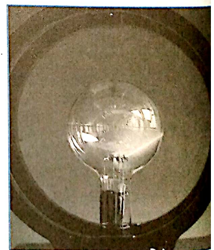
Fig. 7. Dispositif expérimental pour l'étude de la déviation d'un faisceau d'électrons par un champ électrique uniforme *
