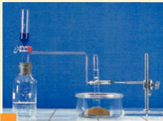
Doc 1 Montage de l'expérience de la synthèse de dioxygène.
