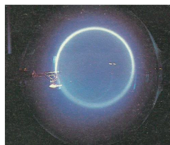
Trajectoire circulaire d'un faisceau d'électrons dans un champ magnétique uniforme : cas où \vec{v}_0 \perp \vec{B}
