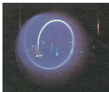
Trajectoire hélicoïdale d'un faisceau d'électrons dans un champ magnétique uniforme : cas où \vec{v}_0 est quelconque
