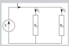
Exprimer l'intensité  $I_1$  en fonction de  $I_0$ ,  $R_1$  et  $R_2$ .
