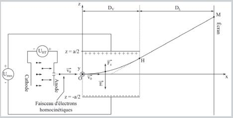
Le faisceau se déplace horizontalement de gauche à droite et revient périodiquement à son point de départ, balayant ainsi régulièrement l'écran à une cadence imposée par le bouton de sensibilité horizontale.
