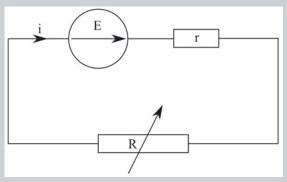
Exprimer la puissance  $P_R$  reçue par le rhéostat en fonction de E, r et R. Quelle valeur faut-il donner à la résistance du rhéostat pour que la puissance qu'il reçoit soit maximale?
