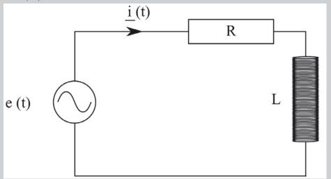
En utilisant la méthode complexe, donner l'expression de l'intensité réelle i(t) du courant traversant le circuit. Retrouver ce résultat en utilisant la construction de Fresnel.
