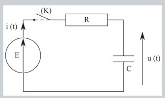
Le condensateur est initialement déchargé; à t=0, on ferme l'interrupteur (K). Rappeler les expressions de u(t), tension aux bornes du condensateur ainsi que celle de l'intensité i(t) de l'intensité du courant traversant le circuit. On se place à un instant t quelconque. Quelle énergie  $dE_q$  est fournie au circuit pendant la durée dt, avec dt infinitésimale? En déduire l'énergie  $E_q$  fournie par le générateur durant la charge. (On considérera la charge achevée pour un temps infini).
