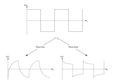
Un oscilloscope utilisé en **mode AC** filtre en fait le signal à visualiser par un filtre passe-haut (dont la fréquence de coupure est de l'ordre de 10 Hz). Son éventuelle composante continue est donc éliminée et il risque de subir des déformations si sa fréquence n'est pas assez importante...
