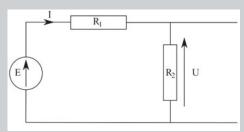
Exprimer la tension U en fonction de  $R_1$ ,  $R_2$  et E.
