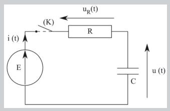
On ferme l'interrupteur à l'instant t=0. Établir les lois de variation des fonctions u(t) et i(t), puis tracer l'allure de leurs graphes. Calculer le temps de montée à 90 %, avec R=1,0 k $\Omega$  et C=1,0  $\mu$ F.
