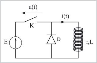
Pour t<0, l'interrupteur est fermé depuis suffisamment longtemps pour être en régime permanent. On l'ouvre à l'instant t=0. Que vaut la tension u(t) qui apparaît aux bornes de l'interrupteur juste après la fermeture? Que vaudraitelle si la diode était supprimée?
