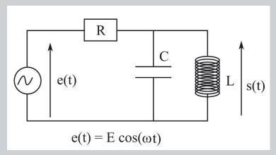
Pour quelle valeur de  $\omega$  le module de l'amplitude complexe associée à la tension s(t) entre-t-il en résonance? Ceci se produit-il toujours? Que vaut, à la résonance, le module et la phase de l'amplitude complexe associée à s(t)?
