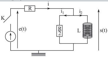
Étudier les comportements asymptotiques quand t tend vers  $0^+$ , puis vers l'infini des intensités des courants i,  $i_1$  et  $i_2$ , de la tension s(t) et de la dérivée de l'intensité du courant traversant la bobine  $\frac{di_2}{dt}$ .
