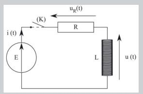
On ouvre l'interrupteur à l'instant t=0. Établir les lois de variation des fonctions u(t) et i(t), puis tracer l'allure de leurs graphes. Expliquer l'apparition d'une étincelle à l'ouverture de l'interrupteur.
