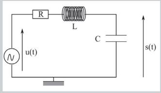
On pose  $\omega_0=\frac{1}{\sqrt{LC}}$  et  $m=\frac{RC\omega_0}{2}=\frac{R}{2L\omega_0}$ . Montrer que le gain maximal de ce filtre dépend de m. En déduire les conséquences que cela implique sur le tracé du diagramme de Bode réel par rapport au diagramme de Bode asymptotique.
