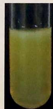
Précipitation de phosphate d'argent.
