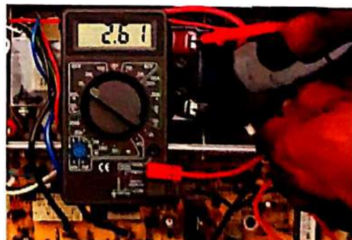
Doc. 2 Une mesure de tension.
