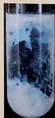
Précipitation du sulfate de baryum.
