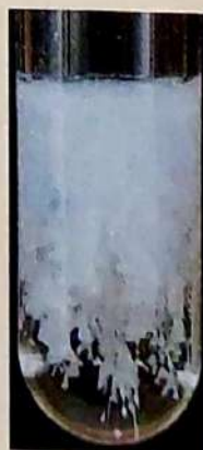
Précipitation du chlorure d'argent.
