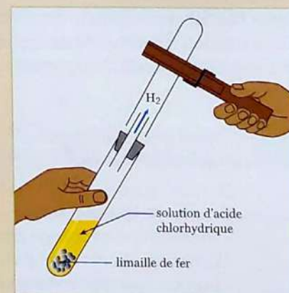
Récupération du dihydrogène.
