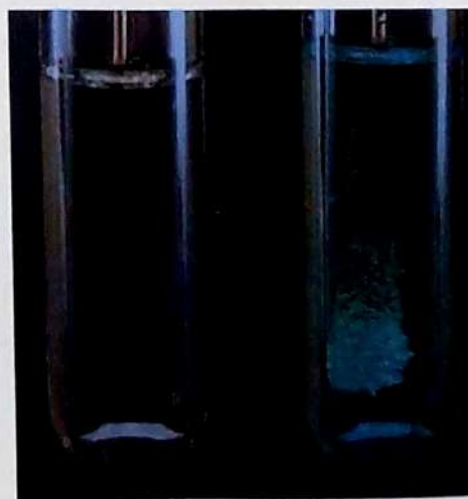
Doc. 2 Un fil de cuivre dans une solution de nitrate d'argent.
