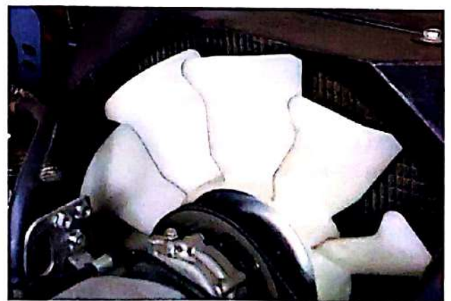
Doc. 9 Ventilateur du radiateur d'une automobile.
