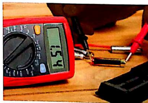
Doc. 2 Tension aux bornes d'une pile.
