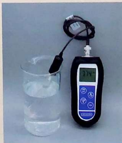
Un pH-mètre avec électrode.
