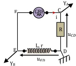
On peut donc conclure que la tension  $u_{CD}$  correspond au signal 1 et que la tension  $u_{ED}$  correspond au signal 2.
