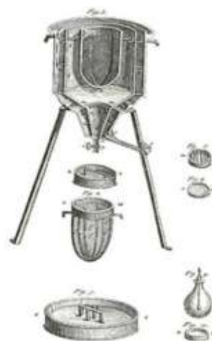
Figure 7.5 : Calorimètre à glace d'Antoine Lavoisier et Pierre Laplace en 1783
