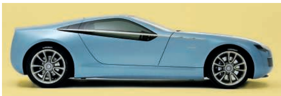
Doc. 3 Prototype de Bertone Birusa (2003), avec une carrosserie en fibre de verre.
