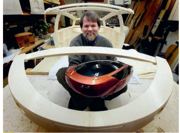
Projet Urbee 2 (2013). Une voiture totalement imprimée en 3D.
