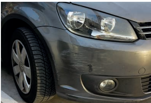
Doc. 2 Aile de voiture en thermoplastique, à la suite d'un accident.
