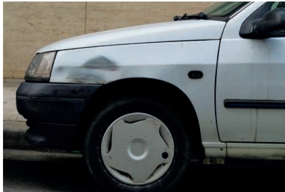
Doc. 1 Aile de voiture en acier, à la suite d'un accident.
