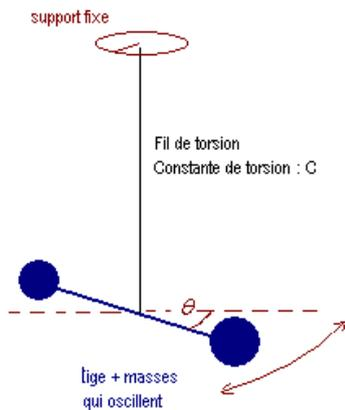
Un pendule de torsion est un dispositif constitué d'une barre horizontale, fixée à un support par l'intermédiaire d'un fil de torsion. Ce fil d'acier exerce un couple de rappel, proportionnel à l'angle de torsion  $\theta$  qu'on lui impose :  $\Gamma = -C\theta$  où  $C$  est la constante de torsion du fil.
