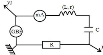
Voie  $y_1$  : on visualise la tension aux bornes de la résistance R.
