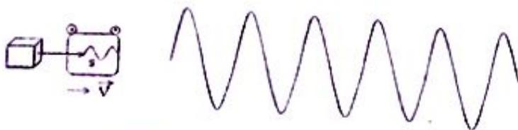
Le papier défile à vitesse constante  $V = 20 \text{ cm.s}^{-1}$ , on obtient le tracé ci-dessus (en grandeur réelle).
