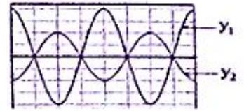
❖ Si  $\Delta\varphi = (2k + 1)\frac{\pi}{2} \Rightarrow \theta = (2k + 1)\frac{T}{4}$  alors les deux fonctions sont dites en quadrature de phase. Quand l'une s'annule, l'autre est maximale ou minimale et inversement.
