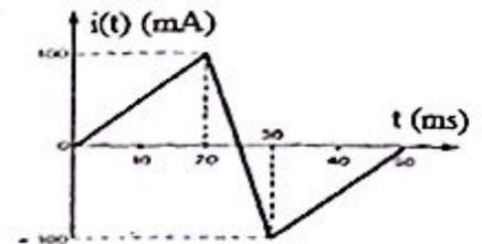
Tracer la représentation graphique de la tension  $u = V_M - V_N$  aux bornes du solénoïde sachant que le sens positif sur le conducteur va de M vers N et que la résistance de la bobine est négligeable.
