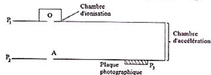
Figure 1 : Spectrographe de masse
