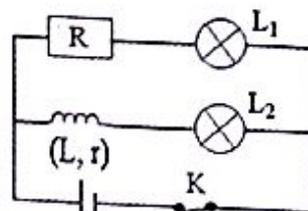
La bobine s'oppose donc à l'établissement du courant ou à sa rupture dans la branche contenant la lampe  $L_2$ .
