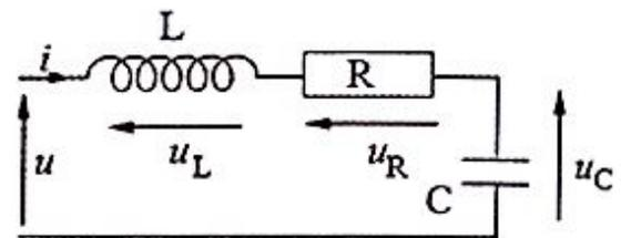
2) Exprimer à l'aide de la loi des mailles l'expression de la tension instantanée  $u(t)$  aux bornes du dipôle RLC en fonction des tensions  $u_R(t)$ ,  $u_L(t)$  et  $u_C(t)$ .
