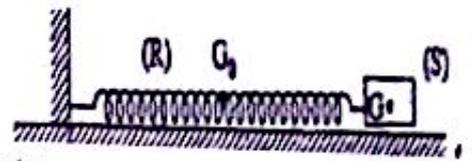
Le solide S se déplace sur un plan horizontal et la position du centre d'inertie G est donnée par le vecteur position  $\overline{OG}$ . L'origine du repère est choisie de telle sorte que lorsque l'oscillateur passe par sa position d'équilibre, le solide se retrouve au point G.
