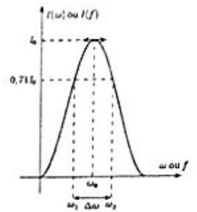
On appelle largeur de la bande passante, la différence  $\Delta\omega = \omega_2 - \omega_1 = \frac{R}{L}$ .
