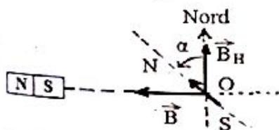
b) Déterminons graphiquement les intensités du champ magnétique créé en O par l'aimant et du champ magnétique horizontal résultant.
