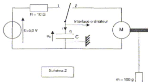
$M$  est un moteur sur lequel est enroulé une ficelle soutenant à son extrémité une masse  $m = 100 \text{ g}$ .
