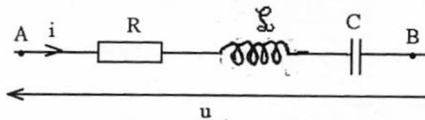
$$u = Ri + L \frac{di}{dt} + \frac{1}{C} \int i dt \text{ avec } i = I_m \cos(\omega t + \varphi)$$
