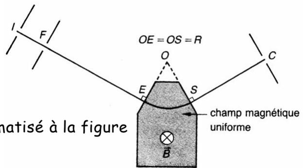
$U = V_I - V_F$  continue et réglable. Ils sont ensuite déviés entre  $E$  et  $S$  par un champ magnétique uniforme de Vecteur  $B$  perpendiculaire au plan de figure, l'intensité  $B$  du champ magnétique restant constante pendant toute la durée d'utilisation. Ils sont enfin recueillis à l'entrée fixe  $C$  d'un collecteur.
