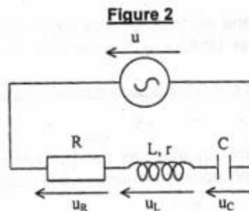
1. Établir l'équation différentielle qui fournit la valeur instantanée  $u(t)$  aux bornes du dipôle en fonction de  $R, r, L, C$  et de la fréquence. En déduire l'expression de l'intensité efficace  $I$  en fonction de  $f$ .
