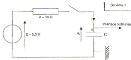
A l'instant  $t = 0$ , on ferme l'interrupteur et on relève la tension aux bornes du condensateur. On obtient la courbe suivante :
