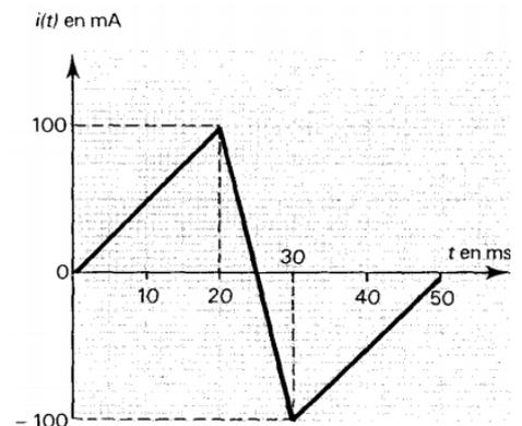
Tracer la représentation graphique de la tension  $u = V_M - V_N$  aux bornes de la bobine sachant que le sens positif sur le conducteur va de M vers N et que la résistance interne est négligeable.
