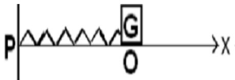
Son extrémité fixe est solidaire d'un point  $P$  tandis qu'un mobile ( $s$ ) de centre d'inertie  $G$  et de masse  $m = 250\text{ g}$  est lié à son autre extrémité. A l'équilibre,  $G$  coïncide avec l'origine  $O$  de l'axe  $Ox$ , donné par la direction du ressort dont l'allongement est nul.
