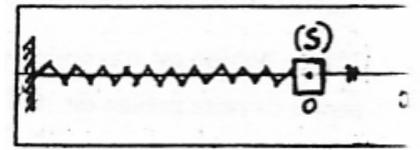
Soit  $\vec{F}' = -\lambda\vec{v}$  la résultante des forces de frottements que subit (S) lors de son mouvement de translation.  $\lambda$  est une constante positive,  $\vec{v} = v_x\vec{i}$  est le vecteur vitesse de (S) avec  $v_x = V_m \cos(\omega t + \varphi)$ .
