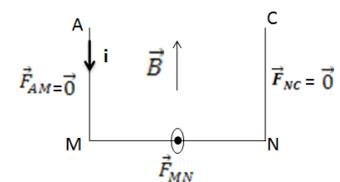
3. Représentons les forces qui s'appliquent sur le cadre (en vue de profil) et calculons de l'angle  $\alpha$
