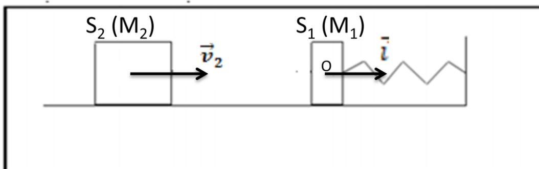
Un solide  $S_2$  de masse  $M_2 = 25 \text{ g}$ , heurte le solide  $S_1$  avec une vitesse  $\vec{v}_2$  dirigée suivant l'axe du ressort.
