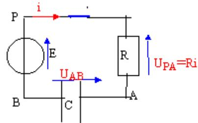
2. équation différentielle caractérisant la tension  $u_c(t)$  aux bornes du condensateur pendant la première demi-période de  $u(t)$
