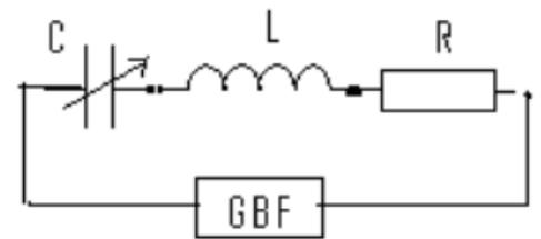
Les élèves veulent observer l'évolution de l'intensité du courant traversant le circuit, sur la voie A, et la tension délivrée par le GBF, sur la voie B, d'un oscilloscope bicourbe.
