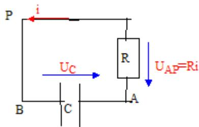
$$u_c(t) = Ri \text{ avec } i = -\frac{dq}{dt} \text{ et } q = Cu_c \text{ soit } i = -\frac{Cdu_c}{dt}$$
