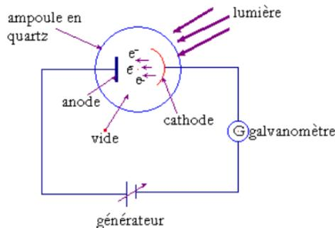
On envoie sur la cathode des rayons lumineux. Si à chaque fois que l'énergie lumineuse est suffisante ( $\nu \geq \nu_0$ ), il y aura extraction d'électrons de la cathode qui seront captés par l'anode et ces déplacements d'électrons entraînent l'existence d'un courant électrique qui circule en sens inverse.
