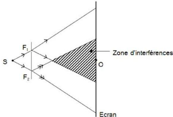
Le faisceau issu de S est diffracté par  $F_1$  et  $F_2$
