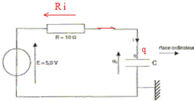
additivité des tensions :  $Ri + u_c = E$  avec  $i = \frac{dq}{dt}$  et  $q = Cu_c$  ; d'où  $i = \frac{Cdu_c}{dt}$
