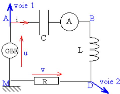
à la résonance d'intensité  $LC\omega^2 = 1$  avec  $\omega = 1000 \text{ rad/s}$  et  $L = 1 \text{ H}$
