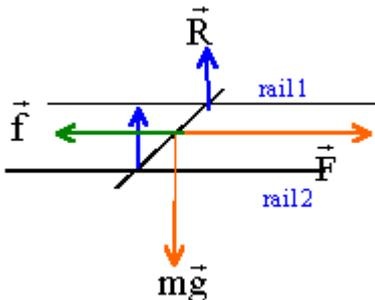
le poids et l'action des rails, perpendiculaires à la vitesse ne travaillent pas.
