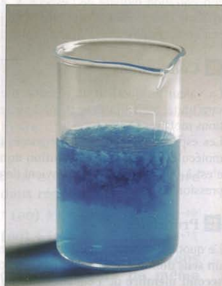
Fig. 2 Caractérisation des ions \text{Cu}^{2+} (aq) par formation d'un précipité d'hydroxyde de cuivre (II) \text{Cu}(\text{OH})_2 (s) .
