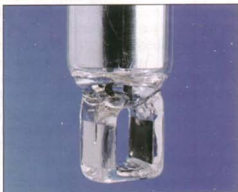
FIG. 1 Cellule conductimétrique : les plaques sont en platine.
