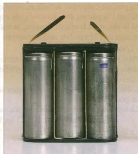
Fig. 9 Pour augmenter la fém, on associe des éléments de fém 1,5 V en série.
