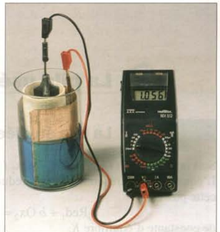
FIG. 3 La fém d'une pile Daniell est voisine de E = 1,1 \text{ V} .
