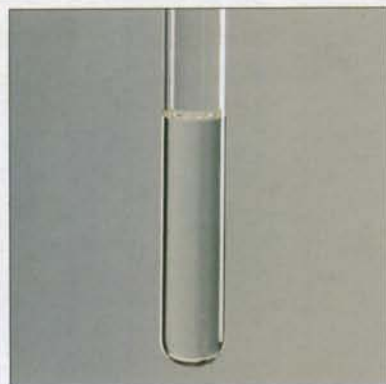
FIG. 2 Dans un second tube à essais, placer 10 mL de thiosulfate de sodium Na_2S_2O_3 de concentration 0,1 \text{ mol}\cdot\text{L}^{-1} .
