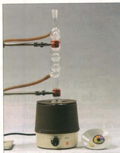
Fig. 13 Hydrolyse de l'éthanoate d'éthyle. On chauffe à reflux pendant environ une heure.
