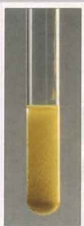
Fig. 1 Précipitation d'iodure de plomb PbI_2 par mélange de solutions d'iodure de potassium et de nitrate de plomb.
