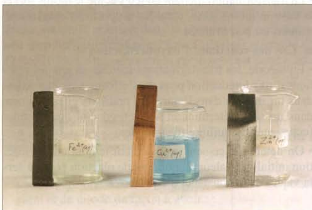
Lame de fer et solution de sulfate de fer (verdâtre). Lame de cuivre et solution de sulfate de cuivre (bleue). Lame de zinc et solution de sulfate de zinc (incolor).
