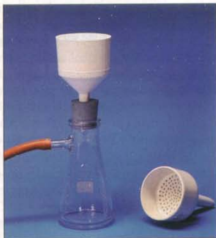
FIG. 1 Dispositif pour filtration sous vide : büchner et fiolle à vide reliée à une trompe à eau.
