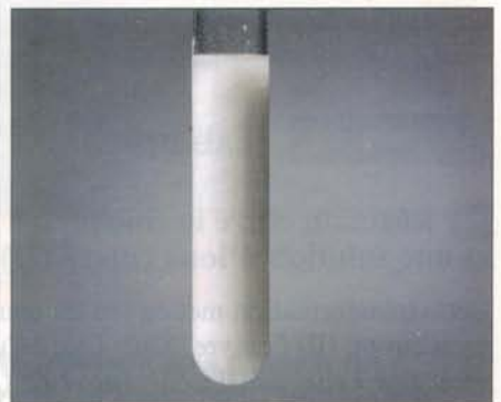
FIG. 4 La réaction entre les ions \text{Ag}^+ (aq) et \text{Cl}^- (aq) est immédiate et forme un précipité blanc de chlorure d'argent.
