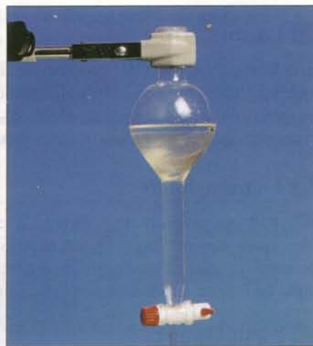
Fig. 6 Extraction par le cyclohexane de l'acétate de linalyle, huile essentielle extraite de la lavande. La phase organique moins dense est au-dessus de la phase aqueuse.
