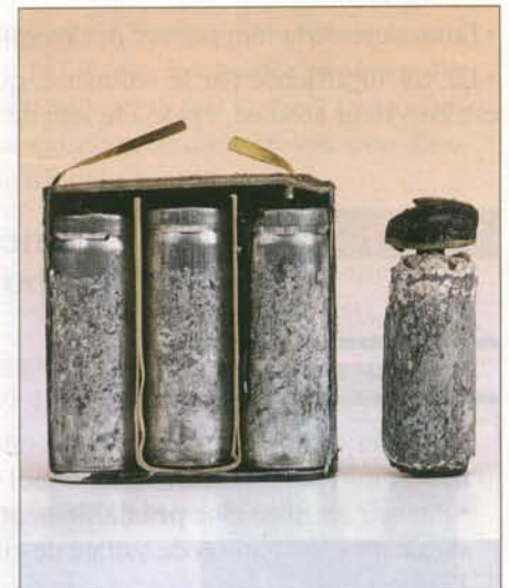
FIG. 6 Une pile de 4,5 V usée ; le zinc constituant le pôle \ominus a été oxydé.
