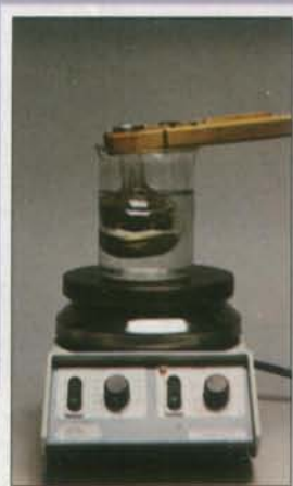
FIG. 5 Caractérisation d'un aldéhyde par formation d'un miroir d'argent.
