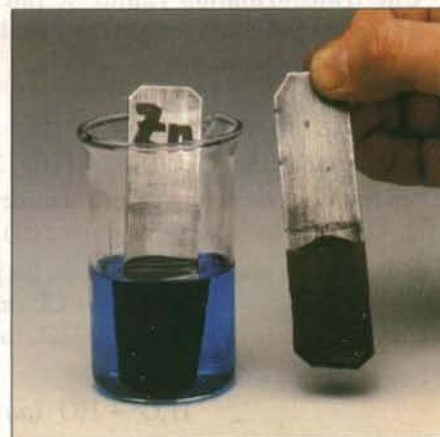
Fig. 1 La réaction entre le zinc métal et les ions cuivre (II) \text{Cu}^{2+} (aq) produit un dépôt rouge (ou noirâtre), constitué de fines particules de cuivre.
