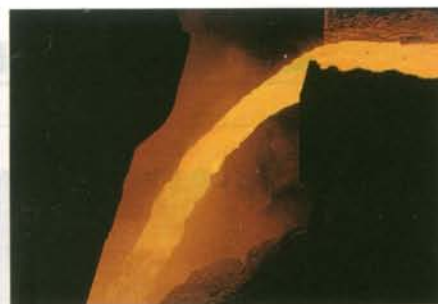
FIG. 10 Coulée de fonte. La réaction de réduction des oxydes de fer s'effectue entre 1\ 000 et 1\ 500\text{ }^\circ\text{C} .
