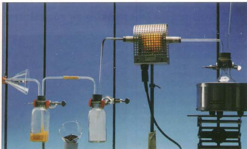
Fig. 2 En passant sur le cuivre, l'éthanol, à l'état de vapeur, est déshydrogéné en éthanal mis en évidence par la 2,4-DNPH.
