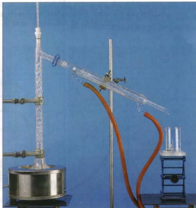
FIG. 1 Distillation fractionnée avec colonne Vigreux.
