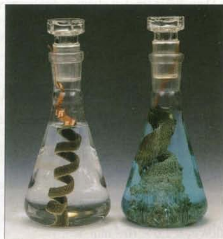
Fig. 4 Oxydation du cuivre par les ions argent : apparition d'ions cuivre (II) (couleur bleue) et d'argent métal.
