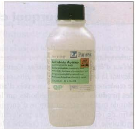
Fig. 1 Corrosif et inflammable, l'anhydride éthanoïque est irritant du fait de sa réaction avec l'eau qui se produit à température ambiante.
