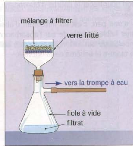
FIG. 3 Filtration sous vide sur verre fritté. La sole de l'entonnoir est formée d'une multitude de grains de verre agglomérés.
