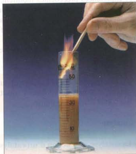
Fig. 6 Catalyse de la dismutation de l'eau oxygénée par les ions \text{Fe}^{2+} (aq) .
