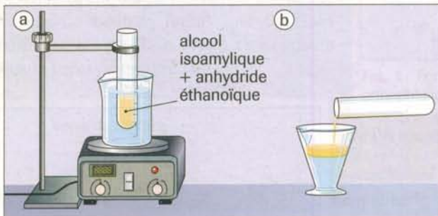
Fig. 2 Préparation de l'acétate d'isoamyle. a. Les deux réactifs au bain-marie. b. On verse dans un verre d'eau salée.
