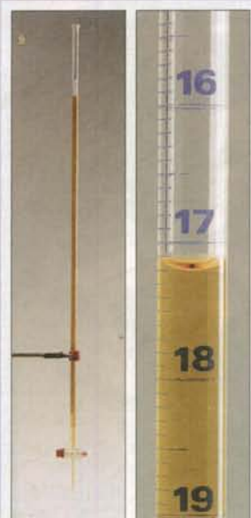
Fig. 2 Burette graduée : le liquide forme un ménisque dans la burette.
