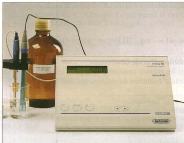
FIG. 3 Mesure du pH d'une solution d'acide éthanoïque de concentration 1,0 \times 10^{-2} \text{ mol} \cdot \text{L}^{-1} .
