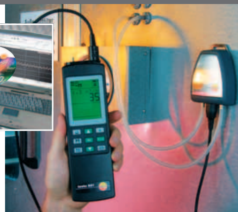
Contrôles de filtres avec sonde externe 100 Pa
