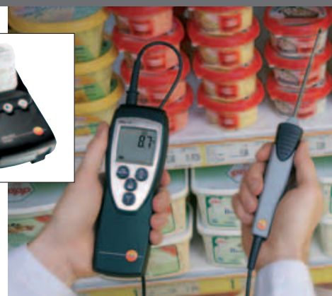
Vérification de linéaires et de rendement frigorifique
