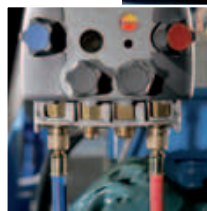
Un système de vannes escamotables protège ces dernières lors de l'utilisation de l'appareil.
