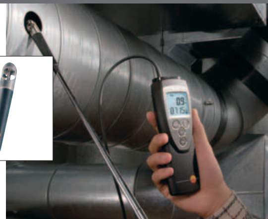
Mesure de vitesse d'air en gaine
