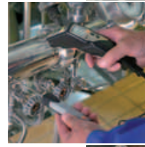
testo 830-T4: Détermination du degré d'émission avec sonde de température externe
