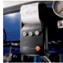
Impression sur site avec imprimante testo des différentes valeurs (option)
