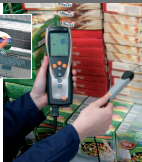
Contrôle de température dans une chambre froide
