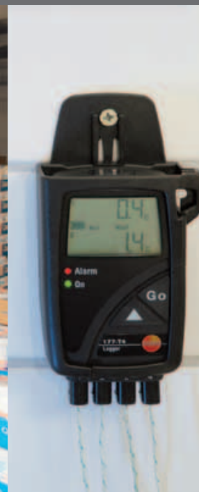
Mesures simultanées sur 4 localisations différentes
