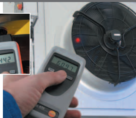
testo 465 et 470, mesure la vitesse de rotation sur pièces en mouvement par procédé optiq. et mécan.
