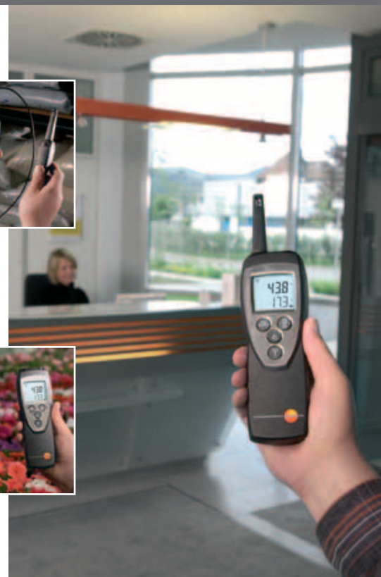
Surveillance de systèmes de climatisation avec tête de sonde d'humidité enfichée
