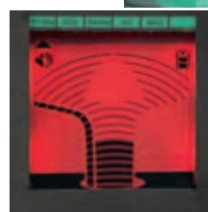
Barregraphe pour localiser précisément la fuite
