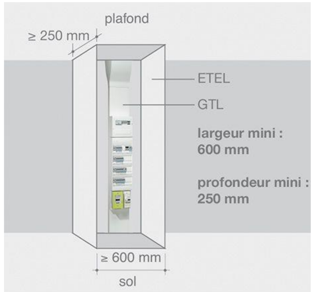
Figure 25: Espace Technique Électrique Logement (ETEL)
