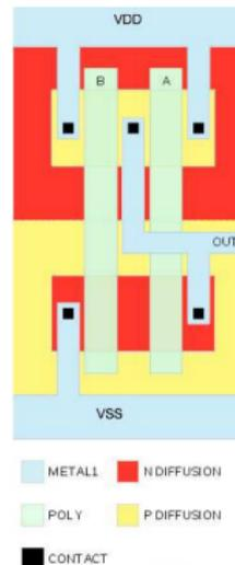
On peut réaliser efficacement des circuits avec des millions de transistors.
