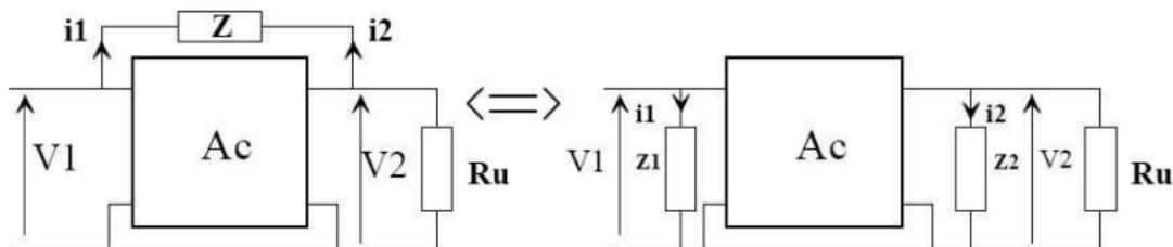
$$\text{avec } \underline{Z}_1 = \frac{\underline{Z}}{1 - A_c} \quad \text{et} \quad \underline{Z}_2 = \frac{\underline{Z}}{1 - \frac{1}{A_c}}$$
