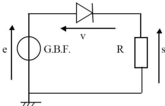
On suppose la diode idéale :  $\Rightarrow$  Etudier  $V_s$  en fonction de  $V_e$  pour  $V_e > 0$  et pour  $V_e < 0$ .
