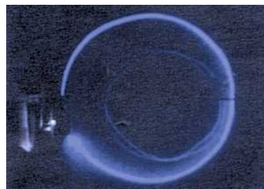
Doc. 3. La lueur émise par le gaz raréfié matérialise la trajectoire des électrons.
